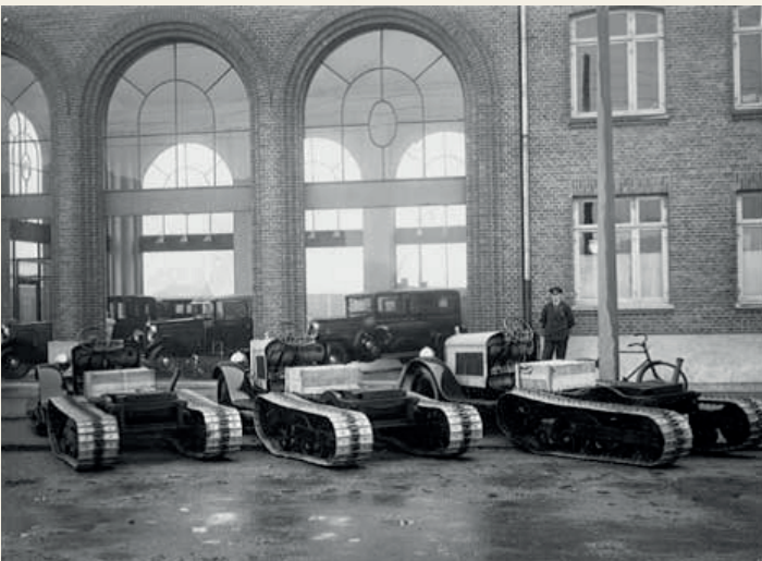
Den danske Citroën-importøren sende tre stk Kegresse P15N understell til Noreg for bygging av karosseri.
